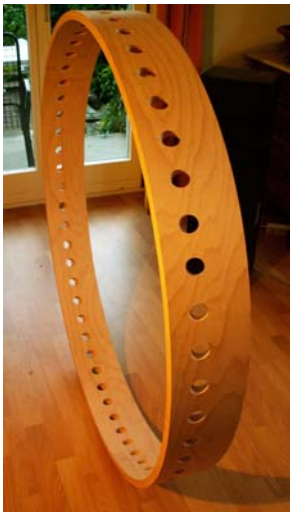
Abbildung 25: Tragring aus verleimten Buchenholz, Ring in Deutschland hergestellt, in der Schweiz gebohrt, Foto Tania Hoesli
