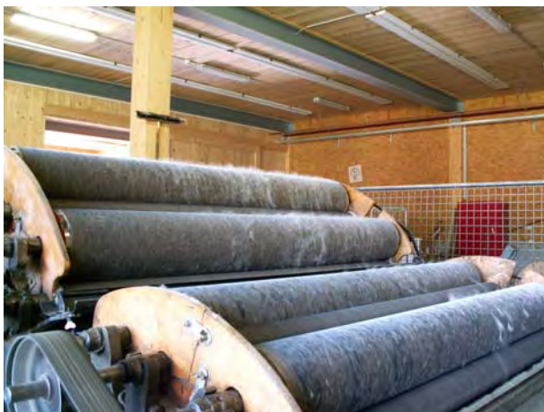
Abbildung 5: Kardiermaschine in Betrieb; einzelne Flocken werden regelmässig verteilt
