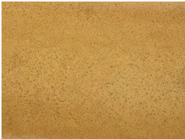
Abbildung 9: Innenstoff mit Pilzbefall
